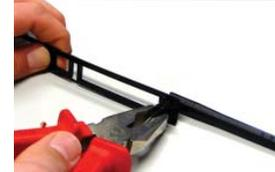
Entfernen Sie mit einer Zange die Antenne aus der Blende indem Sie den Clip-Verchluss leicht zusammendrücken und gleichzeitig die Antenne aus der Blende drücken.
