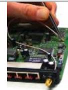
Legen Sie nun die Blende wieder auf die Platine und Verbinden Sie den kleinen U.FL Stecker des Umbausets mit der Buchse auf der Platine.
