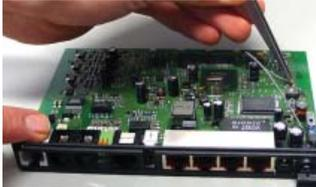
Auf der Platinenoberseite ziehen Sie nun vorsichtig mit der Pinzette, die Steckverbindung der Original-Antenne, ab.
