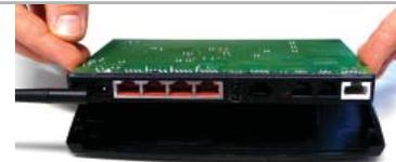
Entnehmen Sie nun die Platine zusammen mit der Anschlussblende, vorsichtig aus der Gehäuseverschalung.
