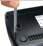
Legen Sie die Fritzbox / Speedport auf die Oberseite und drücken Sie mit dem Schraubenzieher die Rastnasen nach innen. Nehmen Sie das Gehäuseunterteil durch leichtes Ziehen ab.
