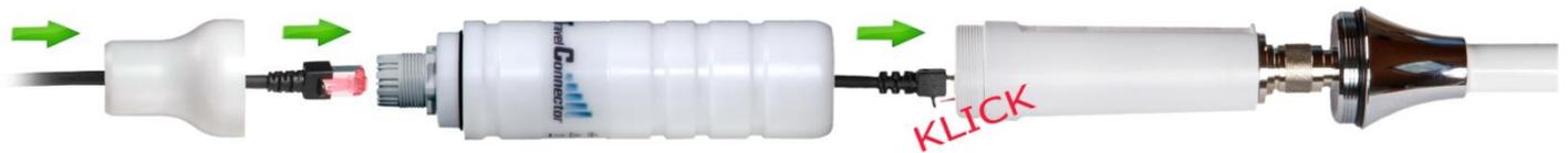
Stecken Sie das Netzwerkkabel durch die Verschlusskappe und dem Enclosure-Antennengehäuse. Verbinden Sie mit einem (KLICK) das Kabel mit der WLAN-Elektronik.
