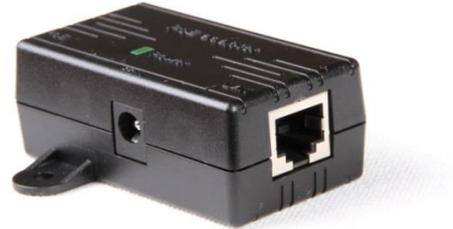
So können Sie die Antenne direkt mit dem PC / Notebook verbinden: Schließen Sie das LAN-Kabel der Antenne mit dem PoE-Adapter an dem PoE Port an. Mit dem im Lieferumfang enthaltenen Patchkabel verbinden Sie Ihren PC / Notebook und den LAN-Port vom PoE-Adapter. Seitlich am PoE-Adapter verbinden Sie den 12V/24V-Hohlstecker mit der Buchse "DC-IN". Die grüne POWER-LED Leuchtet.
