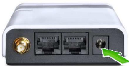
Schließen Sie das Netzteil an die Strombuchse des Routers an und stecken Sie das Netzteil in eine Steckdose mit 110V - 240V AC.
