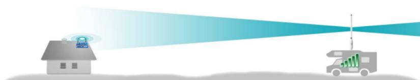
Für optimale Reichweite auf horizontaler Ebene, stellen Sie die Antenne in senkrechter Position mit freier Sicht zum WLAN-Hotspot auf.
