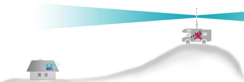
Beachten Sie, dass bei großem Höhenunterschied zum WLAN-Hotspot durch die Abstrahleigenschaften der Antenne nur schlechte bis keine Verbindung hergestellt werden kann.
