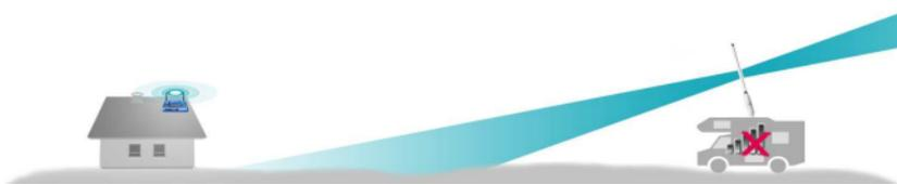
Bei falscher Antennen-Positionierung oder Neigung, ist die maximale Reichweite stark eingeschränkt.
