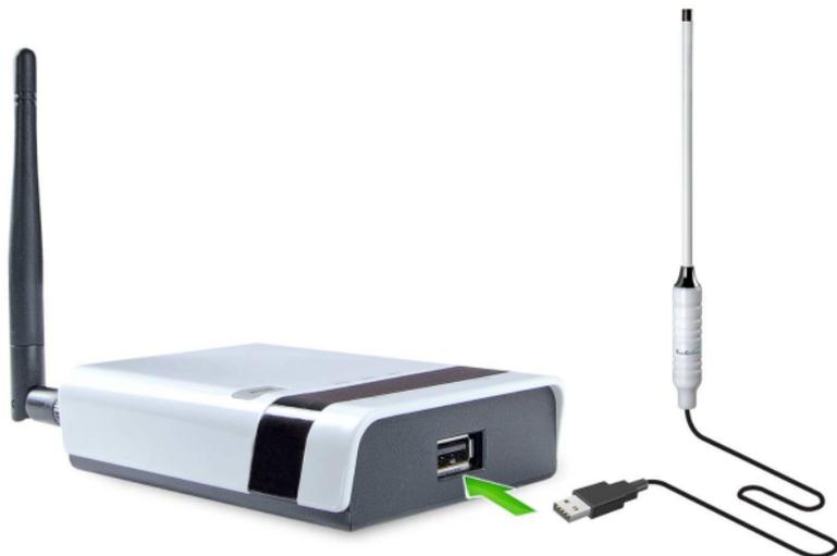
Verbinden Sie den USB-Stecker der Antenne in den WLAN-Router an USB-Port.
