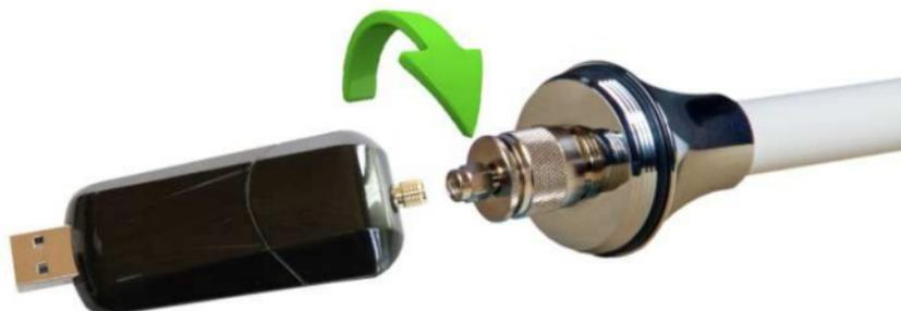
Verbinden Sie das Antennenelement mit der Antennenelektronik. Für optimale Verbindung ziehen Sie die Verschraubung mit einer Zange leicht an.
